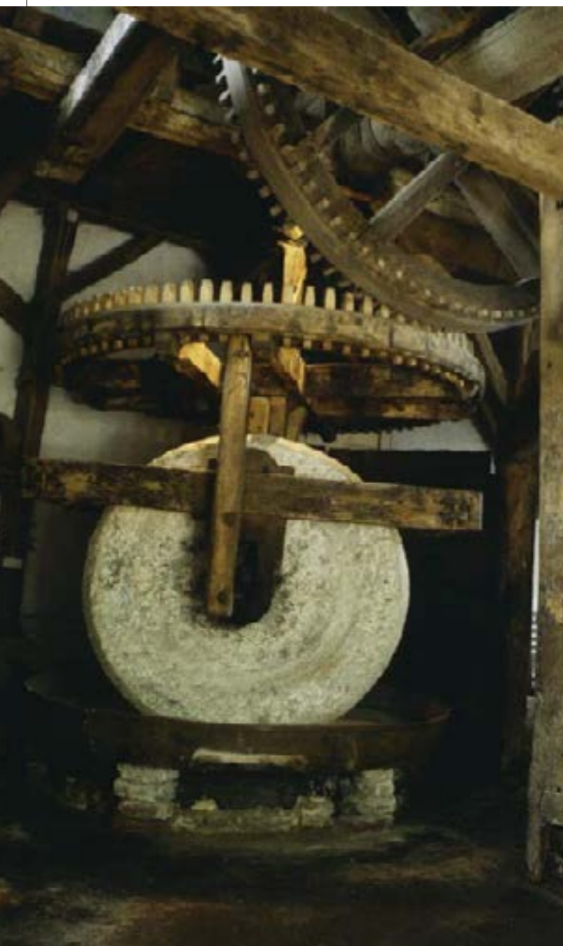
Kollergang der Schrofkmühle in Wegberg. Foto: Ralf Kreiner, o.J.
