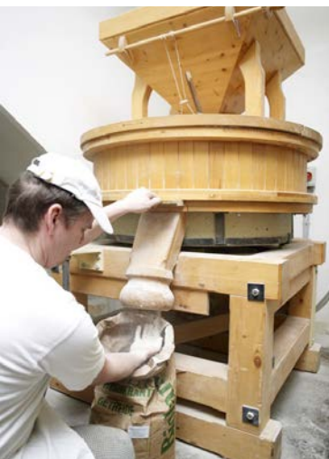
Mehlabfüllung am klassischen Mahlgang in der Mühle der Bäckerei Schomaker, © Andreas Schomaker 2017.
