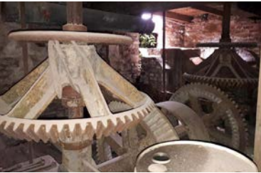
Getriebeboden der Montrauer Mühle, Amel (Belgien), © Ralf Kreiner 2017.
