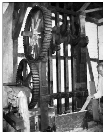
Knochenmühle Finnentrop-Fretter , um 1900 zur Versorgung des benachbarten Hofes Ruhrmann errichtet. Eisernes Stampfwerk vom Typ der 'Kalifornischen Erzepoche' (1860), aus einer Erz- und Schlacke-epoche übernommen. Transmission zum Betrieb anderer Geräte (Schleifstein, Kreissäge) vorhanden. Seit der Instandsetzung 1988 wieder mit einem ober-schlächtigen Wasserrad ausgestattet.
