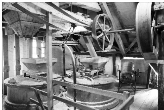
Blick auf die beiden funktionstüchtigen Mahlwerke und die Transmissionen der Sindorfer Mühle. (Foto: N. Schäfer, LVR)
