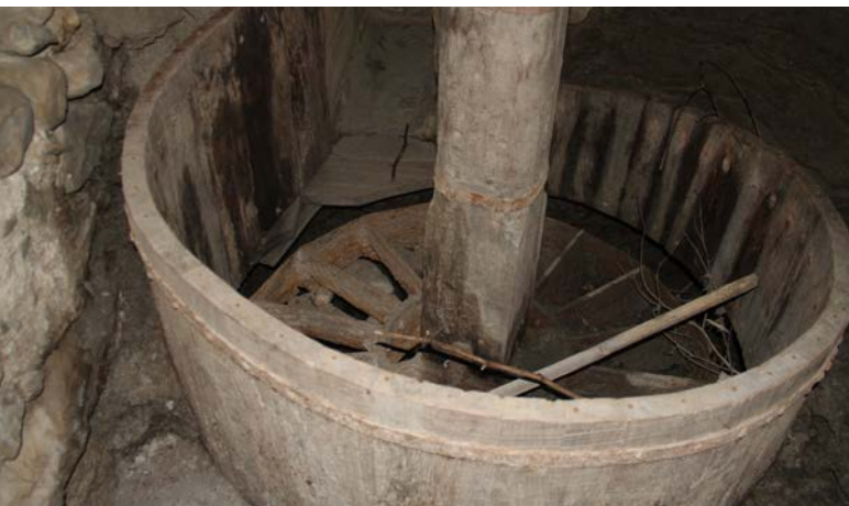
Das Wasserrad mit dem hölzernen Leitapparat in der Moulin de la Bonté, 2018.
