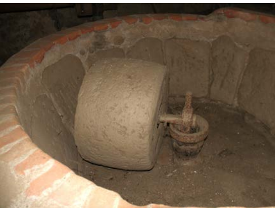
Kollergang mit einem Stein in der Moulin de la Bonté, 2018.
