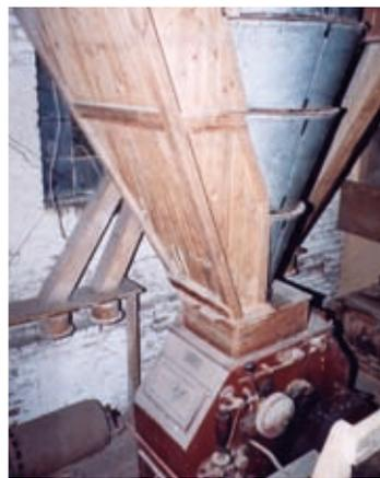
**Bild 8:** Steinboden: (NiG 2) Walzenstuhl mit Vorratsbehälter
