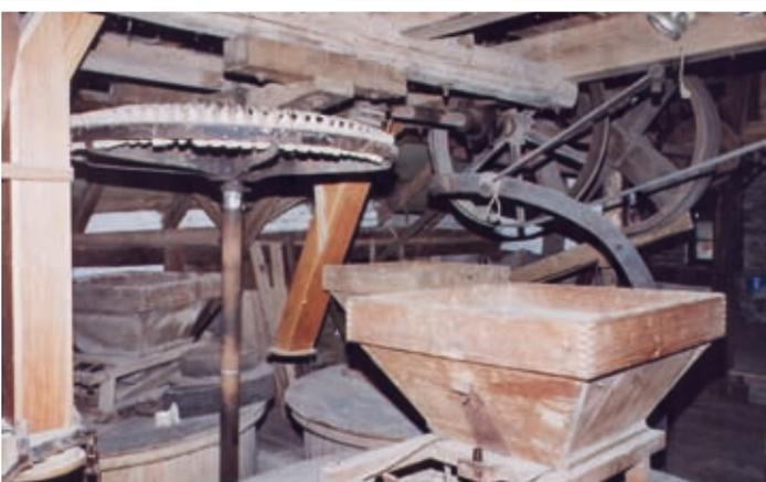
**Bild 12:** Antrieb (Teller + Kegelrad) für Transmission (NiG 4), im Obergeschoß
