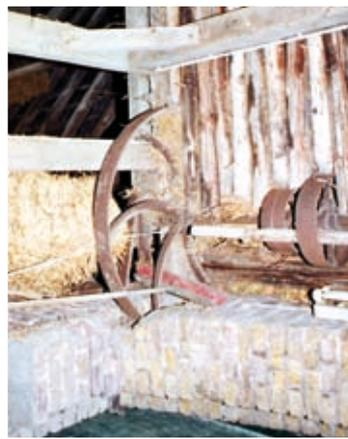
**Bild 20:** Transmission für Antrieb außerhalb der Mühle
