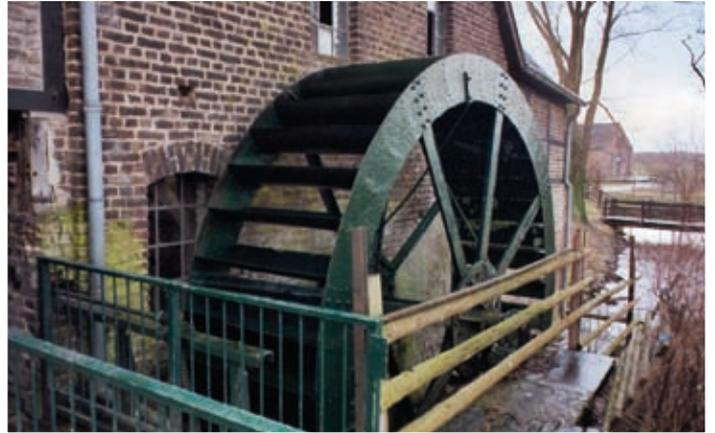
**Bild 17:** Mittelschlächtiges Wasserrad, Breite: 1,25 m, D 500 cm
