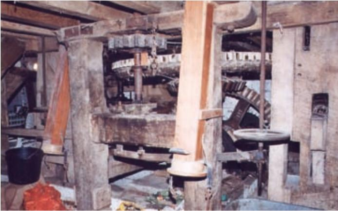
**Bild 1:** Antrieb Schrotgang (NiG 2), oben: Zahnrad auf Mühleisen mit Spurzapfenlager auf Spurbalken mit Stellspindel
