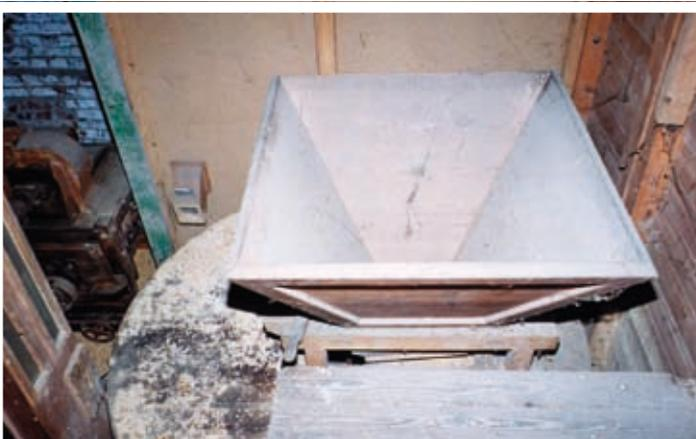
**Bild 9:** Schütt-Trichter Schrotgang (NiG 1)
