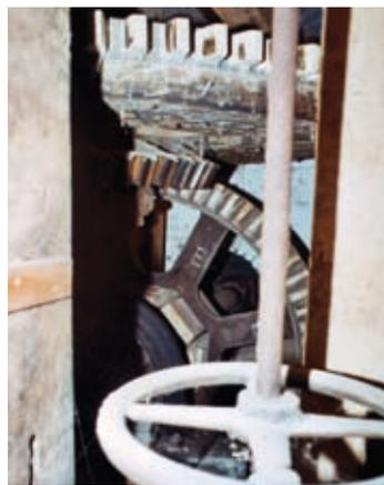
**Bild 5:** Stellrad zur Mahlgrad-Einstellung des Schrotganges (NiG 2)
